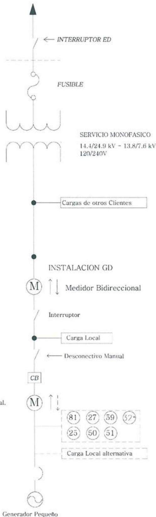
3. Dibujo Unifilar Ilustrativo para GD con Protección Sistema de Distribución Primaria.
